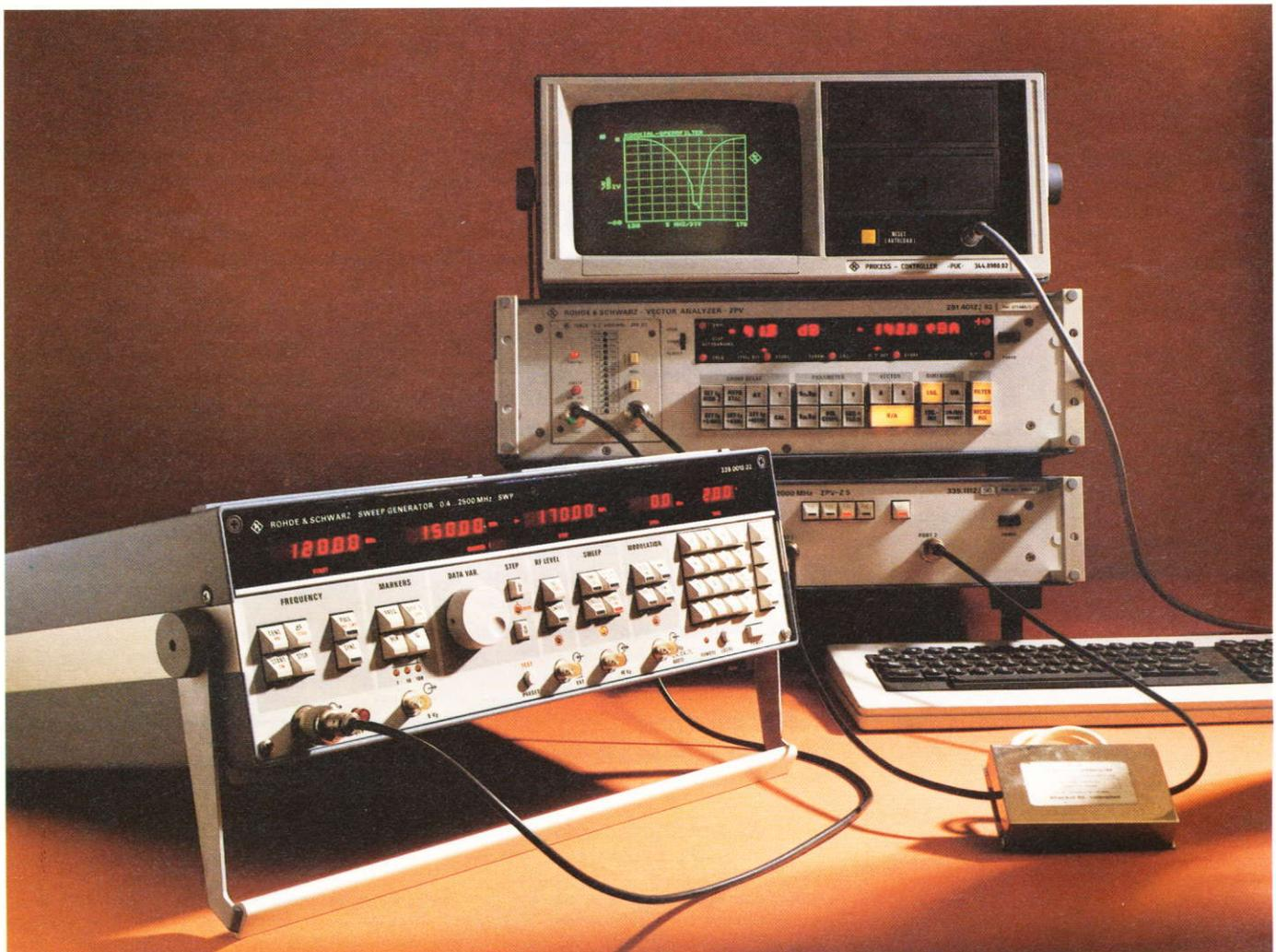
BILD 1 Sweep Generator SWP mit Vector Analyzer ZPV und Process Controller PUC bei der automatischen Messung eines Sperrfilters.
